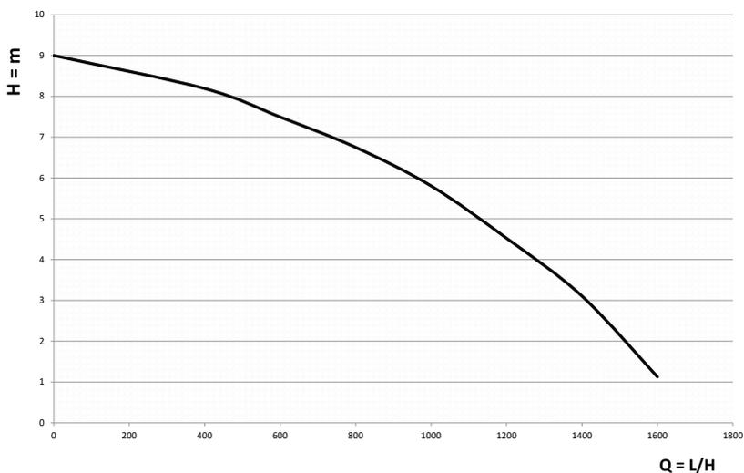
Nota: A curva de rendimento pode variar em função da pressão da água na entrada do pressurizador e da perda de carga das tubulações.
