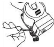
4) Retire os parafusos do fluxostato.
