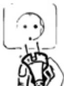
2) Retire o plugue da tomada, desligando o fornecimento de energia elétrica.
