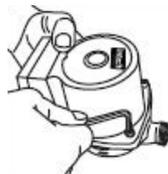
3) Retire os parafusos que fixam a bomba ao motor.
