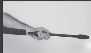
**14** Conecte a lança bico TURBO à pistola, pressione e gire meia volta até travar.
