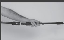
**12** Retire a lança com o bico regulável do extensor, pressionando e girando meia volta, até soltar.
