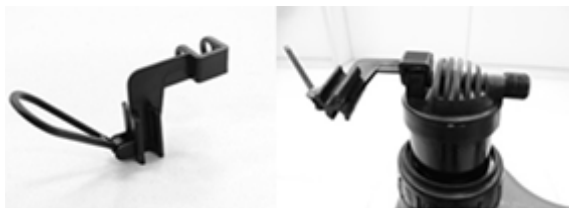
Fig. 5 - Posição do suporte de fixação
