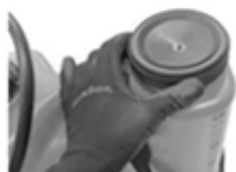
Fig. 11 - Verificação e instalação da peneira
