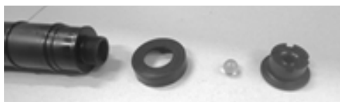
Fig. 17 - Conjunto de vedação e pressão da câmara de compressão (inclui êmbolo, esfera e assento plástico)
