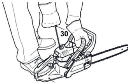
6) Empurre a alavanca do afogador totalmente de volta. Em seguida, com a mão direita puxe novamente o cabo de arranque várias vezes rápida e vigorosamente em toda sua extensão até o motor pegar.
