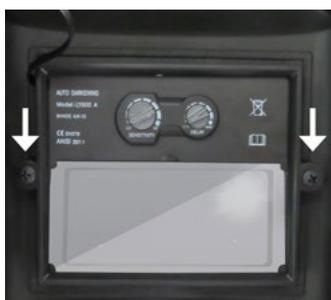
Usando uma chave Phillips, remova os parafusos de fixação do filtro de escurecimento automático, indicados na figura acima.
