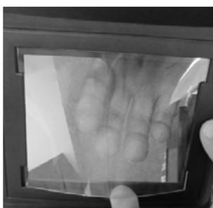
Após retirar o filtro de escurecimento automático, empurre a lente de proteção do lado interno da máscara para o lado externo e com o auxílio da outra mão, puxe a lente protetora para fora.
