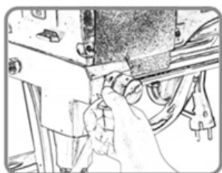
4 - COLOQUE O INTERRUPTOR NO MODO PULVERIZAR
