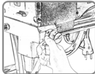
12 - ALTERE A CHAVE PARA O MODO PULVERIZAÇÃO/SPRAY
