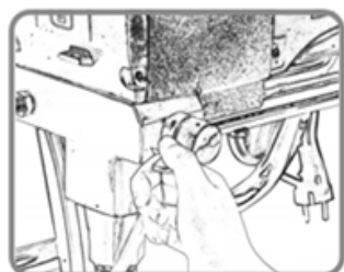
4 - POSICIONE O INTERRUPTOR PARA O MODO PULVERIZAÇÃO/SPRAY
