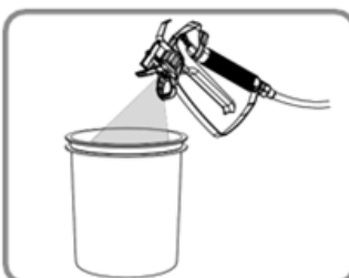
5 - MIRE A PISTOLA DE TINTA PARA O BALDE E ATIVE O GATILHO DO PULVERIZADOR PARA ALIVIAR A PRESSÃO
