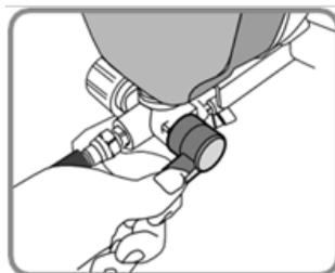
12 - COLOQUE O INTERRUPTOR NO MODO PULVERIZAÇÃO/SPRAY
