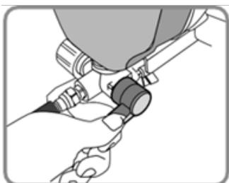
4 - COLOQUE O INTERRUPTOR NO MODO PULVERIZADOR/ SPRAY
