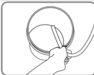
2 - COLOQUE O TUBO DE RETORNO EM UM BALDE QUE POSSA ARMAZENAR RESÍDUOS
