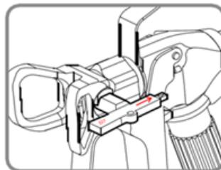
3 - POSICIONE O BICO PARA O MODO PREPARAÇÃO/LIMPEZA
