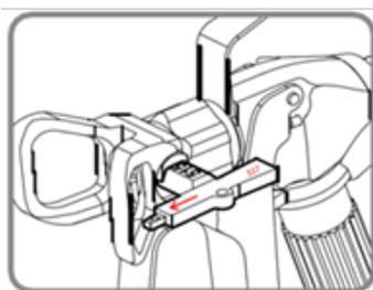
**1 - LOGO APÓS DOS PASSOS DA PREPARAÇÃO, AJUSTE O BICO PARA A POSIÇÃO PULVERIZAR/SPRAY**
