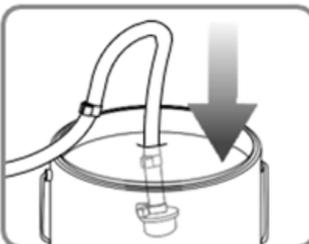
5 - MERGULHE O TUBO DE SUÇÃO EM UM BALDE COM ÁGUA OU SOLVENTE
