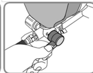
8 - CONFIRME SE O EQUIPAMENTO ESTÁ POSICIONADO NO MODO PULVERIZAÇÃO/SPRAY, CASO NÃO, COLOQUE-O
