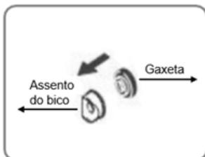
1 - COLOQUE A GAXETA ENCOSTADA NA PARTE PLANA DO ASSENTO DO BICO
