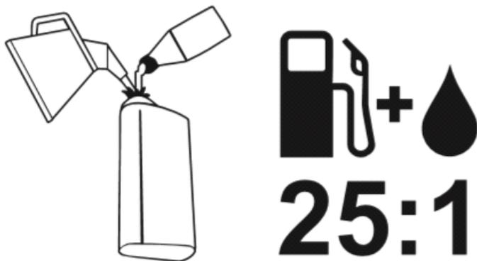
**NOTA:** Use um antioxidante adicionado ao óleo de qualidade expressamente rotulado por resfriamento a ar e uso 2 cursos de motor (JASO FC GRADE OIL ou ISO EGC GRADE). Não use mistura de óleo BIA ou TWC (tipo refrigeração de água de 2 tempos). A proporção recomendada de mistura para gasolina:óleo é 25:1.
