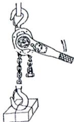
3) Colocar a alavanca seletora na posição "Desce" e mover a alavanca para cima e para baixo, de modo que a carga possa ser descida e o trabalho possa ser concluído.
