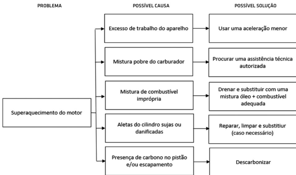
Figura 40: Possíveis causas e soluções para o problema de dificuldade de superaquecimento do motor.
