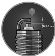
Figura 24: Ajuste necessário da vela de ignição (11).
