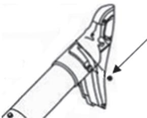
Figura 7: Local de encaixe do parafuso para fixação.
