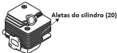
Figura 29: Cilindro do soprador a gasolina.
