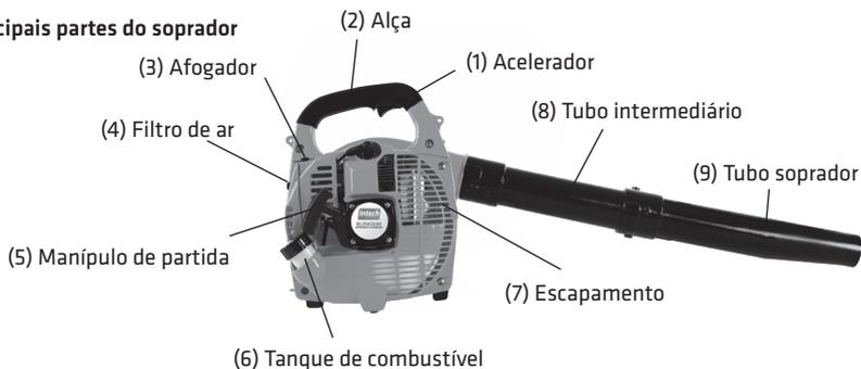
Figura 2: Partes do soprador a gasolina BLOW2600.
