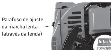
Figura 20: Local do parafuso em que será ajustado a marcha lenta.
