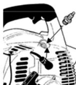
Figura 34: Reinstalação da vela de ignição (11) e cachimbo (13).
