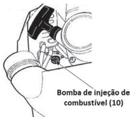
Figura 13: Localização da bomba que irá injetar combustível.
