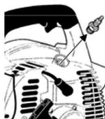
Figura 31: Retirada da vela de ignição (11).
