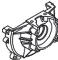
Figura 30: Cárter (21) do soprador a gasolina.
