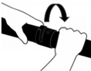
Figura 6: Sentido de encaixe do tubo soprador para fixação.
