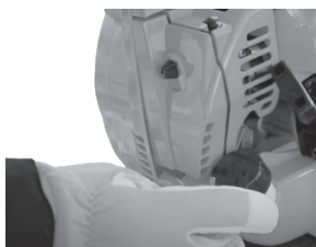
Figura 10: Removendo a tampa do local onde deverá ser despejado o combustível.
