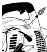
Figura 31: Retirada da vela de ignição (11).
