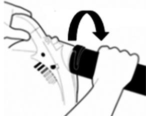
Figura 4: Sentido de travamento do tubo intermediário (8).
