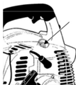
Figura 19: Local a ser realizado a limpeza após a retirada da vela.
