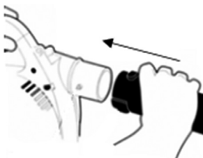
Figura 3: Sentido de encaixe do tubo intermediário no soprador.
