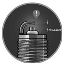
Figura 24: Ajuste necessário da vela de ignição (11).
