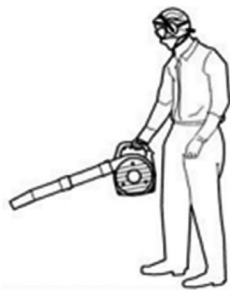
Figura 22: Exemplo de traje a ser utilizado no manuseio do soprador.
