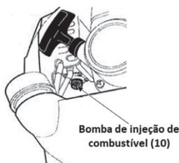
Figura 13: Localização da bomba que irá injetar combustível.
