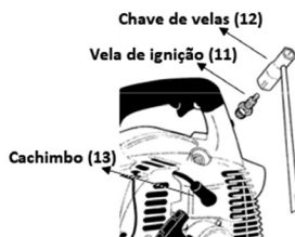
Figura 18: Vela de ignição retirada com a ajuda de uma chave de velas.
