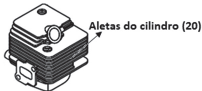
Figura 29: Cilindro do soprador a gasolina.
