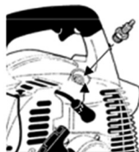
Figura 34: Reinstalação da vela de ignição (11) e cachimbo (13).
