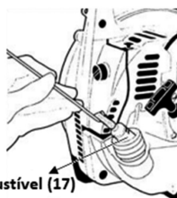
Figura 26: Retirada do filtro de combustível para limpeza.
