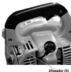
Figura 14: Posição adequada do afogador (3) para a partida do motor a frio.
