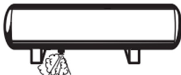
Figura 13: Drenando a unidade
