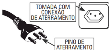
Figura 7: Pino terra e tomada com conector terra
