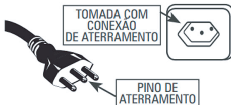
Figura 7: Pino terra e tomada com conector terra
