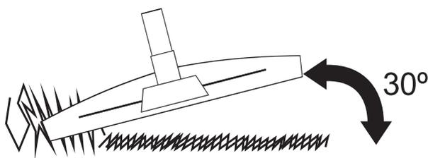
Mova o produto devagar com um arco regular da esquerda para a direita antes de movê-lo de volta para a posição inicial antes de cortar a próxima área
