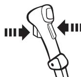
Pressione o controle de acelerador e engrenagem
