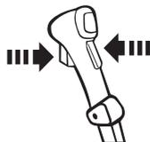
Pressione o controle de acelerador e engrenagem
