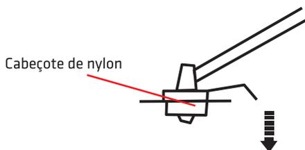
Uma faca integrada vai cortar a linha para o comprimento necessário.
