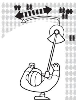
Garanta que o anexo de corte permaneça limpo e livre de cortes que possam causar atolamento. Verifique regularmente. Pare a máquina, posicione a chave de ignição para “PARAR” e desconecte o conector de ignição antes de verificar.
