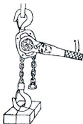
2) Coloque a alavanca reversível na posição "Sobe". Gire a roda (21) no sentido horário quando ela parar, o gancho é posicionado na carga e o freio é engatado, permitindo assim que a alavanca (20) seja acionada para cima e para baixo com a mão e a carga seja levantada.
