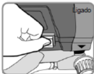
7 - LIGUE O EQUIPAMENTO POR 5 SEGUNDOS E DESLIGUE NOVAMENTE
