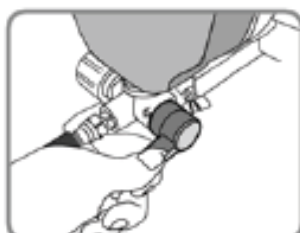
4 - POSICIONE O INTERRUPTOR PARA O MODO PULVERIZAÇÃO/SPRAY
