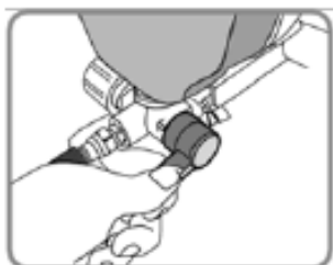
4 - COLOQUE O INTERRUPTOR NO MODO PULVERIZADOR/ SPRAY
