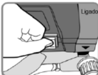
6 - RELIGUE O PLUGUE NA TOMADA E ACIONE A CHAVE LIGA/DESLIGA. O PULVERIZADOR COMEÇARÁ A BOMBEAR E ÁGUA OU SOLVENTE DE LAVAGEM, AGUARDE ATÉ QUE AS BOLHAS DE AR SAIAM PELO TUBO DE RETORNO, ATÉ QUE NÃO HAJA IMPUREZAS
