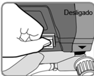
2 - DESLIGUE A CHAVE LIGA/DESLIGA E TIRE O EQUIPAMENTO DA TOMADA
