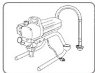
15 - PARA SABER SE A BOMBA E OS TUBOS ESTÃO PREPARADOS PARA O USO, O MOTOR DEVE PARAR. CASO NÃO PARE, REPITA OS PASSOS DE PREPARAÇÃO 15.
