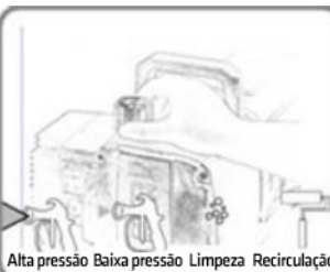
5 - ACIONE NO BOTÃO DE CONTROLE DE PRESSÃO NO MODO BAIXA PRESSÃO
